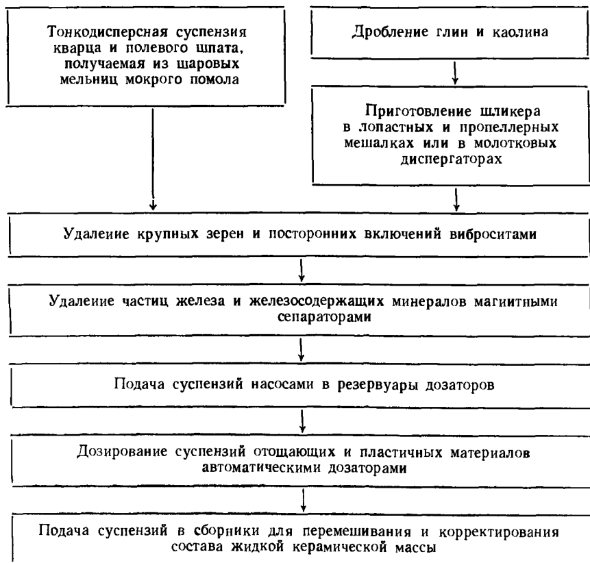
Рис. 62. Схема механизированной линии для приготовления жидкой керамической массы
